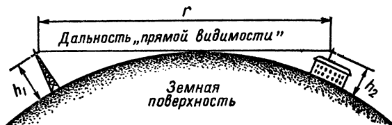
Рис. 1-4. Распространение метровых волн в пределах «прямой видимости».
